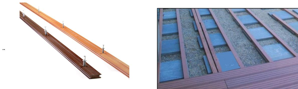
Podkladový rám by měl ležet větší částí na pevném podkladu, to znamená, že v případě použití dlaždic 40x40cm jsou optimální rozestupy mezi dlaždicemi 300mm v podélném směru prken a 200mm v jejich příčném směru.
